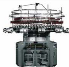
△ TY-DESJ4 型 双面电子式 4 色变色调线提花针织机
