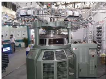
△ RSDT-YQ 移圈罗纹电脑提花机
