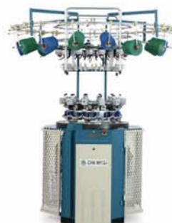
△ CHN-MF12J 单面电子提花针织圆机
