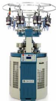
△ SM-DJ2T 双面电子针织圆机
