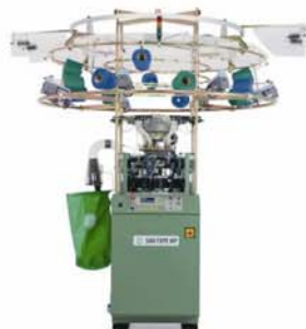
△ SM8-TOP2 MP 40 G 超细针距无缝内衣机
