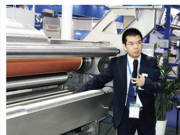
高乐新型双带液机构冷轧染机 DYEPADDER ECONOMICA Nip-in-Trough
