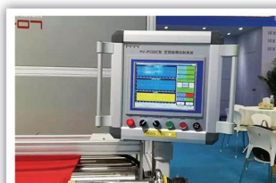
针织物定型克重自动在线测控系统
