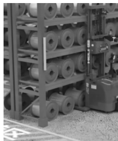
(c)AGV 叉取货架上的经轴
