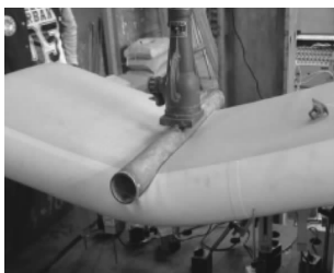
图5 间隔织物增强充气板的三点弯曲测试
