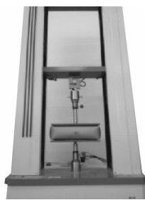
图6 超大隔距经编柔性复合材料的压缩测试
