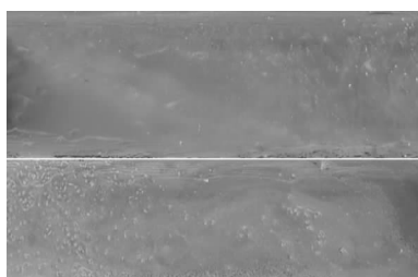
(a)不同直径微球的光子晶体薄膜 (从上到下为 291、254 nm)
