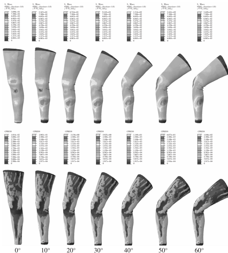
图 6 屈曲过程着服下肢应力云图及软组织表面接触压力云图
