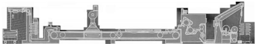
图 3 COMPTX RE 针织物开幅式预缩机
