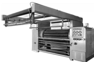
图 16 油压式高速起毛机
