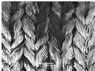
图2 针织面料外观扫描电镜照片
